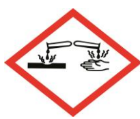
Corrosivo para piel
